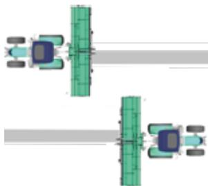
Zentrales Schwaden über 6,40 m in einem Durchgang
