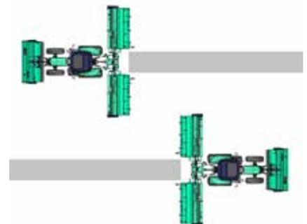
Zentrales Schwaden über 8,40 m in einem Durchgang
